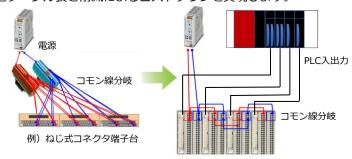
コモン分岐端子台レス!ケーブル長さ&コストダウン!
